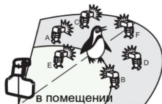
**⚠** При съемке с оптическим беспроводным управлением, ведущее устройство вполне управляет режимом вспышки и их мощностью, которые в Sc/Sn режиме.
