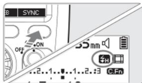
**⚠** Если YN686EX-RT работает как ведомое устройство, нужно через ведущее устройство установить функцию синхронизации.
