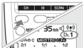
**Установка идентификатора:** Кратко нажмите кнопку [ **ID** ], потом поверните диск выбора для выбора "0 - 9". Нажмите кнопку [SET] для сохранения установки. И нажмите кнопку [ **↶** ], чтобы вернуться в состояние готовности к съемке.
